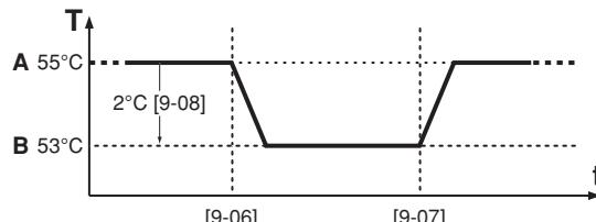
**A** Обычная заданная температура воды на выходе или заданная температура, рассчитанная в зависимости от погоды
