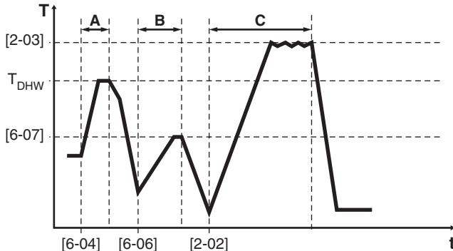
**A Режим расписания хранения:** активирован при [6-04], нагрев воды для бытового потребления до достижения заданного значения интерфейса пользователя горячей воды бытового потребления  $T_{DHW}$  (напр. 55°C).
