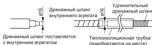
5) Если труба встроенного трубопровода из жесткого поливинилхлорида (номинальный диаметр 13 мм) подсоединяется непосредственно к дренажному шлангу внутреннего агрегата, используйте имеющийся в продаже дренажный разъем (номинальный диаметр 13 мм).
