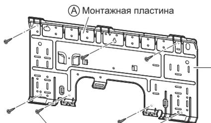
Б Крепежный винт монтажной пластины (местная поставка: M4 x 25)
