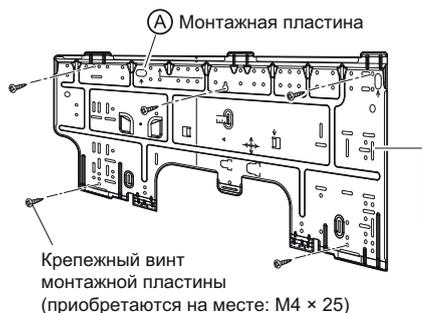
Монтажную пластину установить на стену, которая способна выдержать вес внутреннего агрегата.
